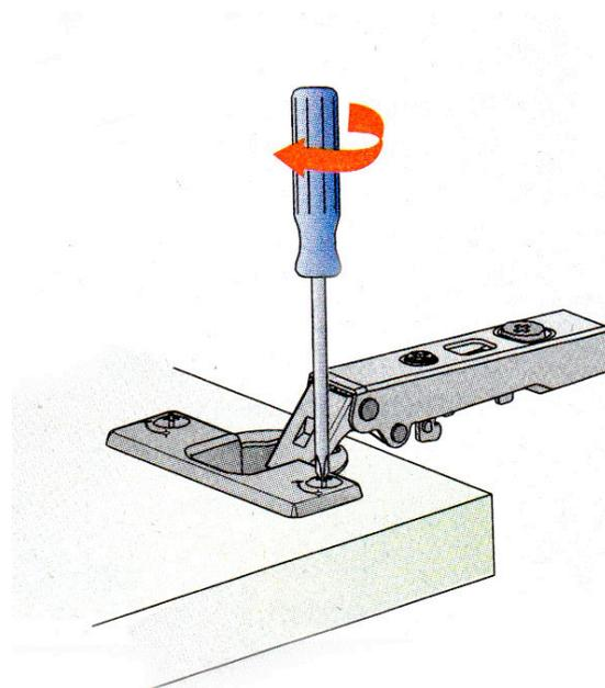
Die Front wird in der benötigten Position an dem Schrankkorpus gehalten und etwas weiter als 90 ° geöffnet, so dass die Montageplatte (das Seitenteil) parallel zur Schrankseite liegt. Abschließend schrauben Sie die Montageplatte (das Seitenteil) an den Schrankkorpus fest.
